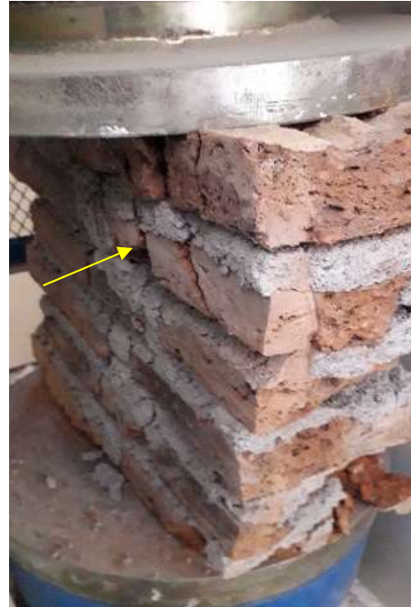
Gambar 4. Retakan batu bata uji 0^\circ
