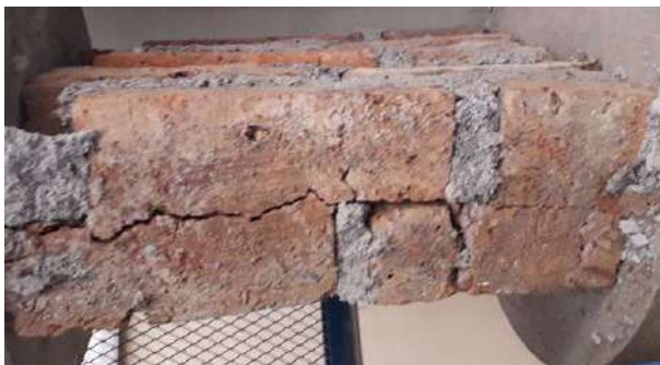
Gambar 7. Arah retakan membelah batu bata pada uji 90°
