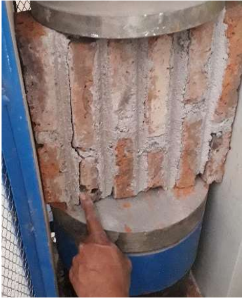
Gambar 6. Retakan batu bata uji 90°
