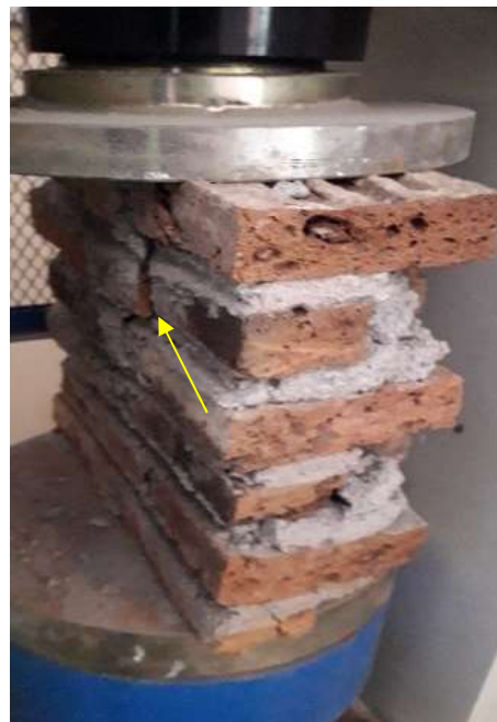
Gambar 5. Retakan batu bata uji 0^\circ
