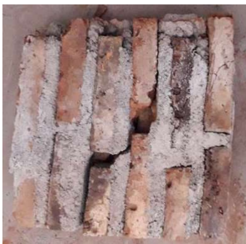
Gambar 8. Retakan batu bata uji diagonal
